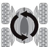
4. Ao mover a alavanca esquerda para trás a roda esquerda roda para trás o Veículo vira à esquerda.
